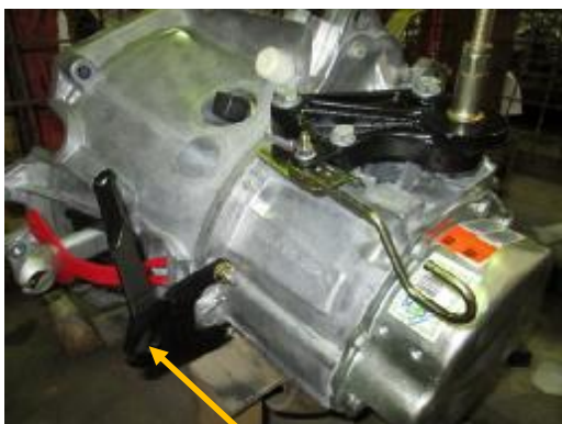
براکت نگهدارنده کابل کلاچ
