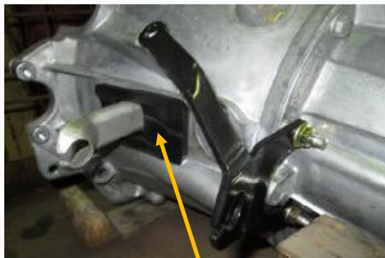
گردگیر لاستیکی در محل خروج دوشاخه کلاچ
