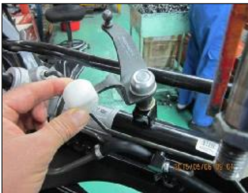
محل درگیری کانال بخاری با لیور اهرم
