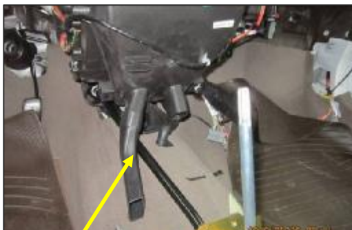
محل درگیری کانال بخاری با لیور اهرم
