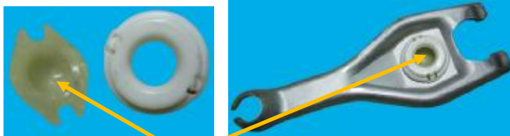
قطعه کانوچونی نصب شده بر روی دوشاخه کلاچ
