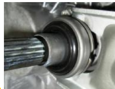
خار نگهدارنده بلبرینگ کلاچ
